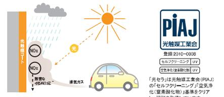
■光触媒コートによる大気浄化のしくみ
